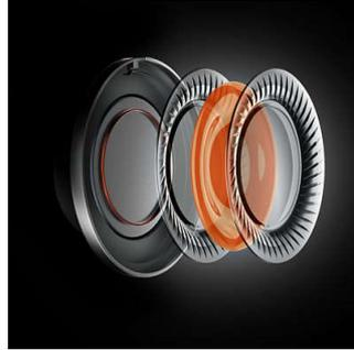
多层驱动单元震膜技术 (LMC) 具有包裹一层阻尼胶的多层聚合物隔音膜。不像传统单层驱动器在较高音频频率表现较为死板、音色还原不受控和不自然，LMC 驱动器的多层结构形成柔性界限，夹有一层阻尼胶。阻尼胶吸收和抑制任何增大的能量，形成平滑平坦的频率响应，进而提供更均衡、自然和精细的高频范围。
