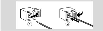
Die Lautsprecherdrähte an die Klemmen **SPEAKERS** anschließen, rechter Lautsprecher an "RIGHT" und linker Lautsprecher an "LEFT", farbiger (markierter) Draht an "+" und schwarzer (nicht markierter) Draht an "-". Den abisolierten Teils des Lautsprecherdrahts lt. Darstellung ganz in die Klemme einführen.
