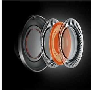
分層振動控制 (LMC) 驅動器採用多層振膜，包有一層阻尼膠。傳統單層驅動器在較高音訊頻率時堅硬，呈現不受控且不自然的音質，而我們的 LMC 驅動器的多層振膜則形成非堅硬的界層，保持軟膠的形狀。軟膠吸收並減弱任何被放大的振幅，使頻率響應更為平滑緩和，從而帶來更均衡、自然和優質的高頻音效。
