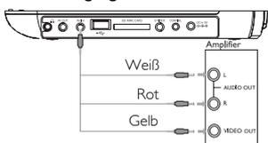
Die Videoeingangsgeräte wie z. B. ein Videoverstärker, ein digitaler Videorecorder oder auch eine Digitalkamera sollten über den RCA-Ausgang am Gerät verfügen. Sollte ein Gerät über keinen RCA-Ausgang verfügen, wenden Sie sich gegebenenfalls an Ihren Fachhändler.
