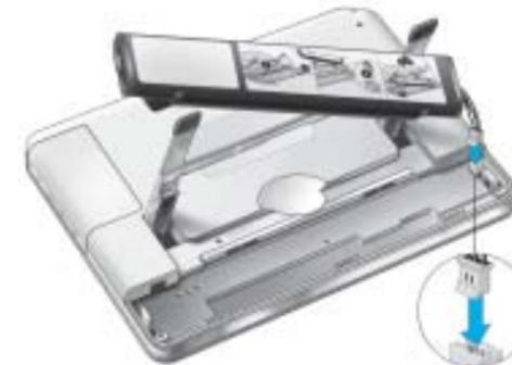
**4** Schieben Sie die rechte Seite des Akkus unter den Haken am Gerät.
