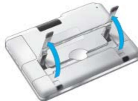
**2** Öffnen Sie die Abdeckung des Akkufachs: drücken Sie diese nach unten und ziehen Sie sie heraus in dargestellte Richtung.
