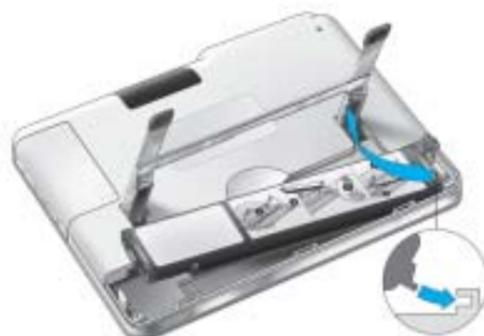
**5** Drücken Sie die linke Seite des Akkus nach unten und lassen Sie einrasten. Schließen Sie die Abdeckung des Akkufachs.
