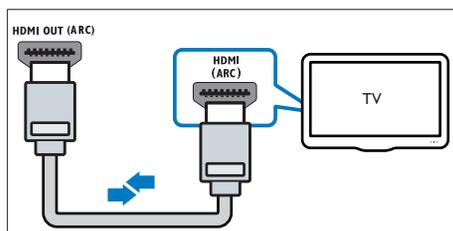
1 С помощью высокоскоростного кабеля HDMI подключите разъем **HDMI OUT (ARC)-TO TV** на звуковой панели SoundBar к разъему **HDMI ARC** на телевизоре.
