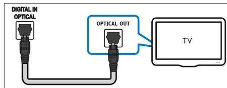
1 С помощью оптического кабеля подключите разъем **OPTICAL** панели SoundBar к разъему **OPTICAL OUT** телевизора или другого устройства.
