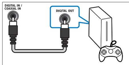
1 С помощью коаксиального кабеля подключите разъем **COAXIAL** панели SoundBar к разъему **COAXIAL/ DIGITAL OUT** телевизора или другого устройства.
