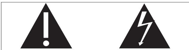
Der "Lichtblitz" steht für mögliche Stromschläge, die durch unisoliertes Material innerhalb des Geräts ausgelöst werden können. Entfernen Sie aus Sicherheitsgründen keinesfalls die Abdeckung des Produkts.
