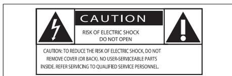
Ce symbole éclair signifie que les composants non isolés de votre appareil peuvent provoquer une décharge électrique. Pour la sécurité de votre entourage, ne retirez pas le couvercle du produit.
