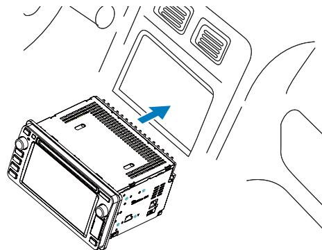
7 用螺钉将装置固定到仪表盘。
