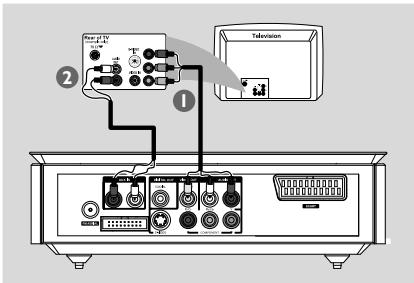
1 С помощью компонентных видеокабелей (красный/синий/зеленый, в комплект не входят) подсоедините разъемы **Y Pb Pr** системы DVD к соответствующим входным разъемам компонентного видео (обозначены как Y Pb Pr или YUV) телевизора.
