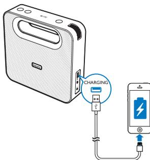
No modo de fonte de alimentação CA, conecte ao seu dispositivo móvel com um cabo USB (não fornecido).
