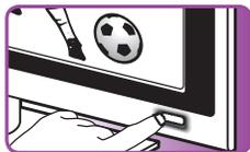
**2** Mantenga pulsado el botón de selección del dispositivo (por ejemplo, **TV**) durante **5 segundos** hasta que el indicador rojo de configuración **@** parpadea.
