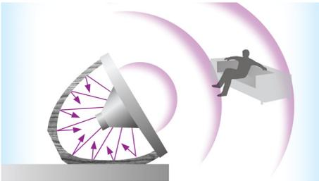
A cobertura posterior curvada com design cuidado deste altifalante de base Philips cria uma estrutura acústica extremamente eficaz para reprodução do som. A sua curva perfeita reforça a rigidez da caixa do altifalante, reduzindo significativamente a ressonância interna e eliminando a vibração e distorção do som. Poderá desfrutar de som límpido e fantástico com altifalantes com um design maravilhoso.
