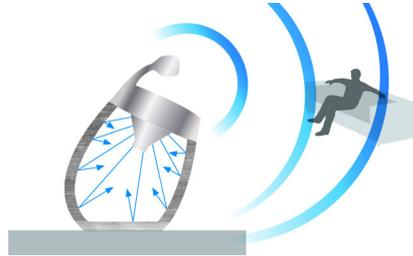
La parte posterior curva ha sido diseñada delicadamente para generar una estructura acústica muy efectiva para la reproducción del audio Philips. Su diseño refuerza la rigidez de la carcasa del altavoz, lo que reduce significativamente la resonancia interna y elimina la vibración y la distorsión del sonido. De esta forma, puedes disfrutar de un sonido súper nítido en unos altavoces de diseño sorprendente.
