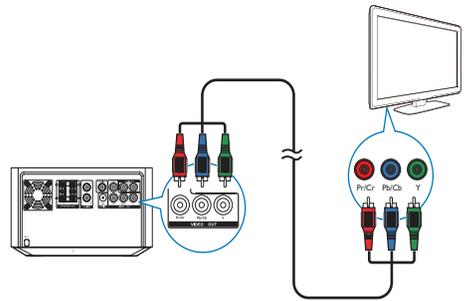
Schließen Sie einen Fernseher mit Progressive Scan für eine bessere Videoqualität über Component-Videokabel an.
