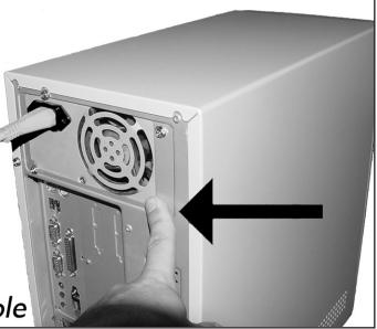
**E** Toque una parte metálica no pintada (por ejemplo, radiador o cualquier parte no pintada de las carcasa de su ordenador).
