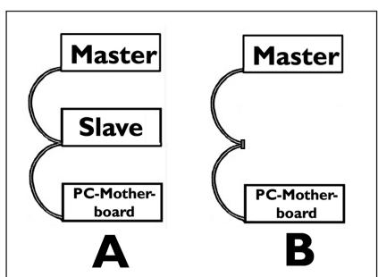
**E** Conecte el cable IDE como se indica en A (2 dispositivos) o B (sólo 1 dispositivo). No elija 2 dispositivos "Master" o 2 dispositivos "Slave" en 1 cable.
