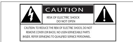
Значок молнии указывает на наличие неизолированных материалов в устройстве и опасность поражения электрическим током. В целях безопасности не снимайте корпус. Восклицательный знак указывает на функции, перед использованием которых необходимо внимательно ознакомиться с прилагаемым руководством во избежание последующих проблем с работой и обслуживанием устройства.
