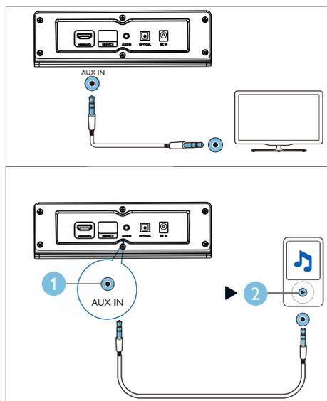
Koristeći 3,5 mm stereo audio kabl, povežite **AUX IN** konektor na vašem soundbar zvučniku sa **AUX** konektorom na televizoru ili drugom uređaju.
