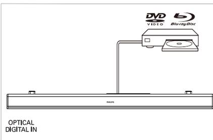
Pomoću optičkog kabela, povežite **OPTICAL** konektor na soundbar zvučniku sa **OPTICAL OUT** konektorom na TV-u ili drugom uređaju.
