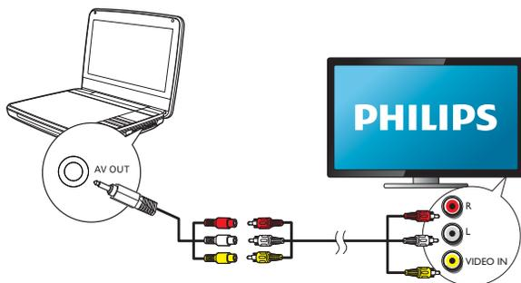
Zapojte AV kabely (AV kabel připojený k televizoru není dodáván s přístrojem) ke konektorům podle barev:
