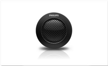
由於聚醚亞胺 (PEI) 的重量輕、強度高、穩定性高和耐高溫, 是用於製造半球形高音喇叭的理想材料。在低音喇叭內側, 小型薄膜 (半球形開口) 可以產生高頻音。這些半球形 PEI 甚至可以捕捉到最高的音符, 能讓您感受到流暢的音感和全音域的高音。半球形外形也可以將聲音擴散到四週, 使您從汽車內的每個座位上都能聽到高音效果。
