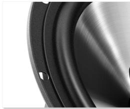
將具有高度響應性的丁基合成橡膠將低音喇叭薄膜連接到喇叭框架, 形成一個環迴懸掛系統。當聲音訊號到達低音喇叭內側的錐形筒時, 堅硬而富有彈性的丁基合成橡膠環迴配件將錐形筒保持在適當位置, 當訊號強度變得很強時, 保護它免受可能會出現的強勁向上力或向下力的衝擊。這樣, 低音喇叭才可以承受住陡然激增的強勁旋律, 甚至可從小喇叭提供流暢的低音反應, 並將聲音失真降至最低。
