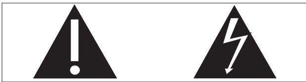
此“闪电标志”表示设备中的未绝缘材料可能导致触电。为了家人的人身安全，请不要拆除产品外壳。
