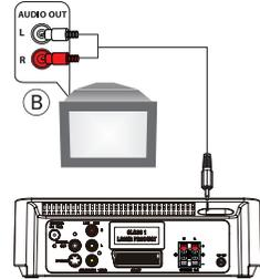
B Um den Ton des Fernsehgeräts über dieses System zu hören, verwenden Sie ein Cinch-Kabel (nicht mitgeliefert), um die **AUX IN**-Buchse (3,5 mm) mit der **AUDIO OUT**-Buchsen am Fernsehgerät zu verbinden.
