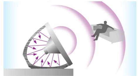
La parte posterior curva ha sido diseñada delicadamente para generar una estructura acústica muy efectiva para la reproducción del audio. Su diseño refuerza la rigidez de la carcasa del altavoz, lo que reduce significativamente la resonancia interna y elimina la vibración y la distorsión del sonido. De esta forma, puedes disfrutar de un sonido súper nítido en unos altavoces de diseño sorprendente.
