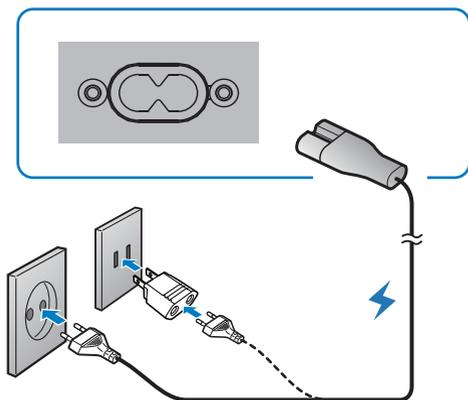
Um adaptador de plugue redondo para terminal achatado é fornecido. Se as tomadas na parede forem destinadas a plugues de pino achatado, primeiro conecte o adaptador com firmeza ao plugue de alimentação.
