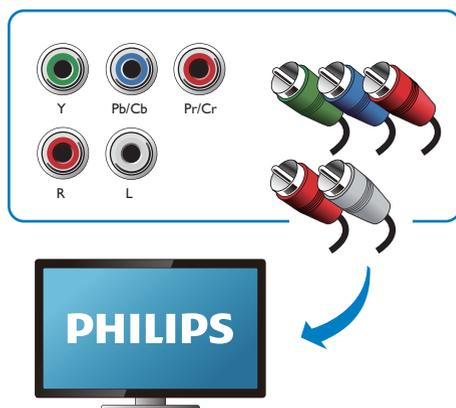
Conecte uma TV com Progressive Scan usando cabos de vídeo componente para uma obter qualidade de vídeo mais alta.
