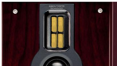
钹质带状高频单元是单极高频单元, 从前方产生动态、清脆的声音。它是高端音频系统中常用的部件, 可再现具有极高保真度的声音。传统的圆锥形和圆顶高频单元采用定向动圈原理, 而钹质带状高频单元以 180 度辐射方式辐射高频。这样显著增大高音部分声谱的宽度, 并扩展最佳听音的区域, 即使是小型音频系统, 也能产生宽广、晶晰而自然的声音。
