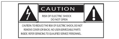
Il "fulmine" indica che il materiale non isolato nell'unità potrebbe causare una scossa elettrica. Per la sicurezza di tutti nell'ambiente domestico, non rimuovere la protezione dal prodotto. Il "punto esclamativo" richiama l'attenzione sulle funzioni per le quali è necessario leggere attentamente la documentazione allegata per evitare problemi di funzionamento e manutenzione.
