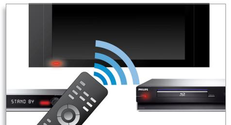
EasyLink 让您可以透过一个遥控器控制多台设备。它使用 HDMI CEC 行业标准协议，并通过 HDMI 连接线在设备之间共享功能。只需轻触按钮，您就可以同时操控支持 HDMI CEC 的所有连接设备。待机和播放等功能尽在您的掌握之中。
