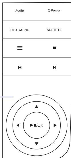
Nospiediet taustiņu **OK/▶**, lai sāktu, pauzētu vai atsāktu atskalošanu. Lai apturētu atskalošanu, divreiz nospiediet taustiņu **■** vai pārslēdziet ierīci citā atskalošanas režīmā. Lai piekļūtu iespēju izvēlnei, atskalošanas laikā nospiediet taustiņu **☰ (OPTIONS)**.
