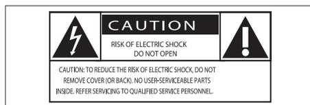
Il "fulmine" indica che il materiale non isolato nell'unità potrebbe causare una scossa elettrica. Per la sicurezza di tutti nell'ambiente domestico, non rimuovere la protezione dal prodotto.
