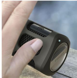
SHOQBOX dispone de un sensor de movimiento. Solo tienes que desplazar el dedo sobre el sensor de izquierda a derecha o al contrario para saltar a la pista siguiente o a la última. Coloca la mano sobre el sensor durante un segundo para poner la música en pausa. Hazlo de nuevo para volver a reproducir. El sencillo control por gestos te permite controlar la música de la forma más fácil.
