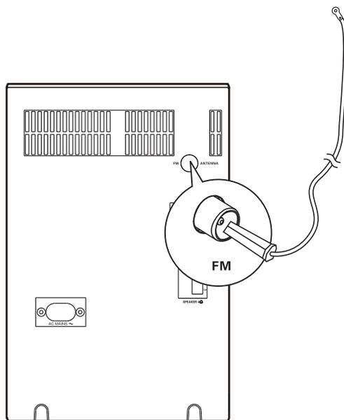
Csatlakoztassa az FM-antennát a hátsó panelen található **FM ANTENNA** aljzathoz.
