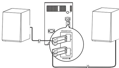
Hangszórókábel-csatlakozók csatlakoztatása a **SPEAKER OUT** aljzatokhoz.
