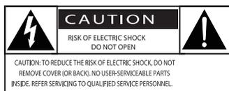
El símbolo del rayo indica que los componentes sin aislamiento dentro del dispositivo pueden generar una descarga eléctrica. Para la seguridad de todas las personas de su hogar, no quite la cubierta.
