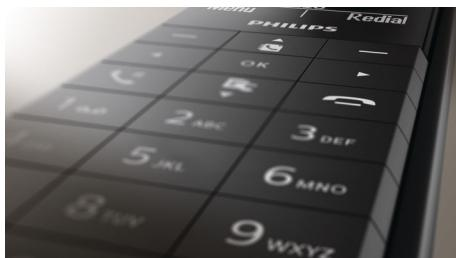
Το βαθμονομημένο πληκτρολόγιο σάς επιτρέπει να εντοπίζετε εύκολα κάθε πλήκτρο, είτε καλείτε αριθμούς είτε πληκτρολογείτε μια νέα επαφή στον τηλεφωνικό κατάλογο. Η λεπτομερής μελέτη των υλικών και των δομών πληκτρολογίου, καθώς και οι εκτεταμένες δοκιμές χρηστών, έχουν ως αποτέλεσμα τη σωστή ισορροπία ανάμεσα στην ανταπόκριση των πληκτρών και την ασκούμενη πίεση, προσφέροντας πληκτρολόγηση ακριβείας.
