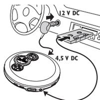
Remarque : Si votre autoradio possède une prise LINE IN, il est préférable de l'utiliser pour le branchement à l'autoradio plutôt que la cassette-adaptatrice. Branchez la ligne de signal à cette prise LINE IN et à LINE OUT sur l'appareil.
