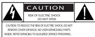
Ova „munja“ označava da neizolirani materijal unutar uređaja može prouzročiti strujni udar. Nemojte uklanjati poklopce radi sigurnosti svih osoba u vašem domaćinstvu. „Uskličnik“ skreće pozornost na značajke za koje biste trebali pažljivo pročitati priloženu literaturu da biste sprječili probleme pri radu i održavanju.
