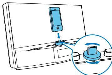
**3** 调节接口两侧的缓冲装置以稳固手机。
