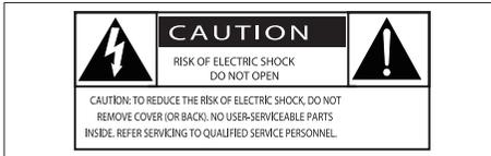
El símbolo del rayo indica que los componentes sin aislamiento situados dentro de la unidad pueden generar descargas eléctricas. Para garantizar la seguridad de todas las personas de su hogar, no retire la cubierta del producto.
