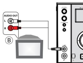
B Per ascoltare l'audio del televisore attraverso il lettore DVD, utilizzare un cavo cinch (non fornito) per collegare **AUX-IN** sul pannello anteriore del lettore DVD ai rispettivi jack **AUDIO OUT** sul televisore.
