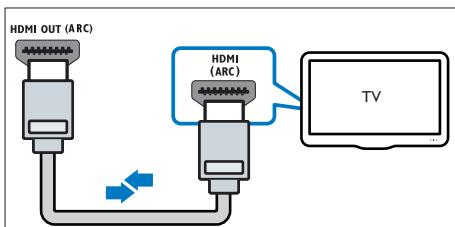
1 За допомогою високошвидкісного кабелю HDMI з'єднайте роз'єм **HDMI OUT (ARC)** на системі домашнього кінотеатру з роз'ємом **HDMI ARC** на телевізорі.
