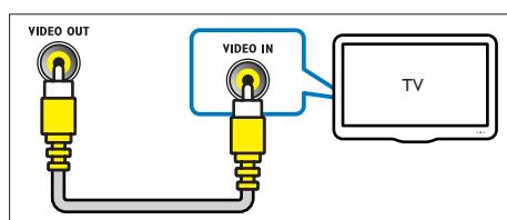
**1** 使用复合视频线缆，将家庭影院上的 **VIDEO OUT** 接口连接至电视上的 **VIDEO IN** 接口。
