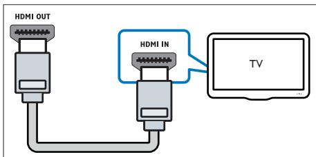
**1** 使用高速 HDMI 线缆，将家庭影院上的 **HDMI OUT (ARC)** 接口连接至电视上的 **HDMI** 接口。
