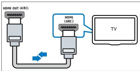
**1** 使用高速 HDMI 线缆，将家庭影院上的 **HDMI OUT (ARC)** 接口连接至电视上的 **HDMI ARC** 接口。
