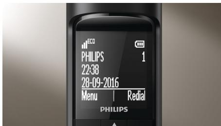
Μια ασπρόμαυρη αναστρέψιμη οθόνη LCD υψηλής αντίθεσης εξασφαλίζει εύκολη ανάγνωση και συνδυάζεται άφογα με τη συνολική κομψή εμφάνιση του Philips Faro.
