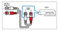
Mediante un cable analógico, conecte los conectores AUX del SoundBar a los conectores AUDIO OUT del televisor o de otro dispositivo.
