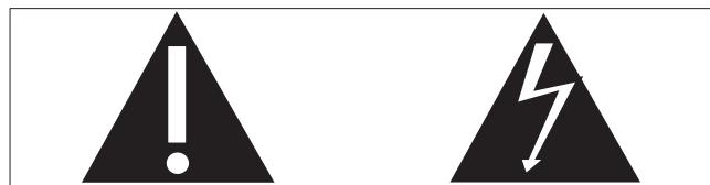
“Молния” обозначает неизолированный материал в устройстве, который может привести к поражению электрическим током. В целях безопасности не снимайте крышку устройства.
