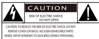
Эта «молния» указывает на то, что неизолированный материал внутри устройства может вызвать поражение электрическим током. Для безопасности всех в вашем доме, пожалуйста, не снимайте корпус.
