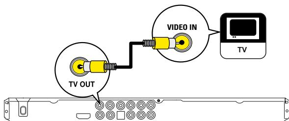
1 用复合视频线（提供）将DVD播放机的TV OUT插孔和电视上的视频输入插孔连接起来。
