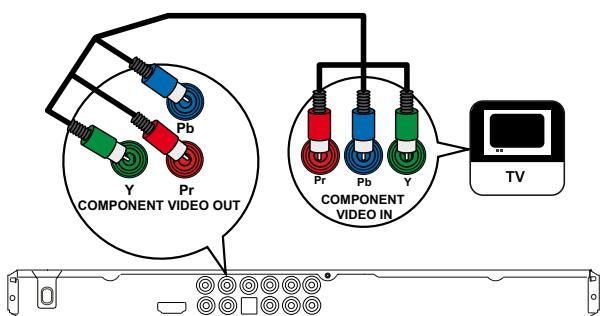
1 用色差视频线（不提供）将DVD播放机上的Y Pb Pr插孔连接到电视机上的色差视频插孔。
