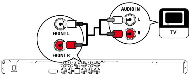
1 用音频线（提供）将DVD播放机的AUDIO OUT FRONT L/R连接到电视上的音频输入插孔。
