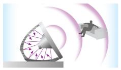
Il rivestimento posteriore ricurvo dalle linee ricercate di questo sistema docking per altoparlanti crea una struttura acustica efficace per una riproduzione sonora ottimale. Le curve semplici rafforzano la rigidità della cassa degli altoparlanti riducendo in maniera sensibile la risonanza interna ed eliminando le vibrazioni e la distorsione audio. Potrai così ascoltare un audio cristallino con degli altoparlanti dal look mozzafiato.
