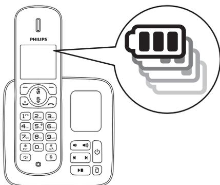
L'icône de batteries indique le niveau actuel de charge des batteries.
