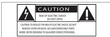
Значок молнии указывает на наличие неизолированных материалов в устройстве и опасность поражения электрическим током. В целях безопасности не снимайте корпус устройства.
