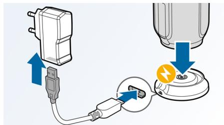
Uzlādējiet skaļruni vienkārši un ērti, pievienojot to kompaktam uzlādes dokam, kas novietojams jebkurā vietā. Uzlādējot skaļruni klausīšanās laikā, varat baudīt mūziku bez ierobežojumiem. Lai klausītos mūziku, esot ceļā, skaļruni var uzlādēt, izmantojot standarta USB vadu.
