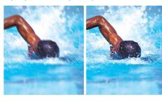
Функция прогрессивной развертки удваивает разрешение изображения по вертикали, что выражается в заметно более четком изображении. Вместо передачи на экран сначала поля с нечетным числом строк, а затем поля с четным числом строк, оба поля записываются одновременно. Мгновенно создается полноэкранное изображение с максимальным разрешением. При такой скорости ваш глаз воспринимает более четкое изображение, не имеющее строчной структуры.
